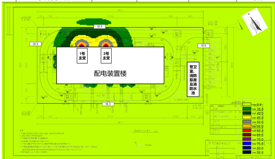
图 4-8 本期西庄二 110kV 变电站 2 台主变投运后厂界噪声贡献等声级线图
