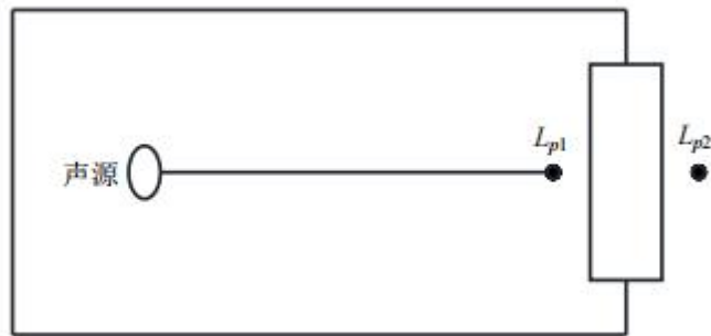
图 4-5 室内声源等效为室外声源图例
