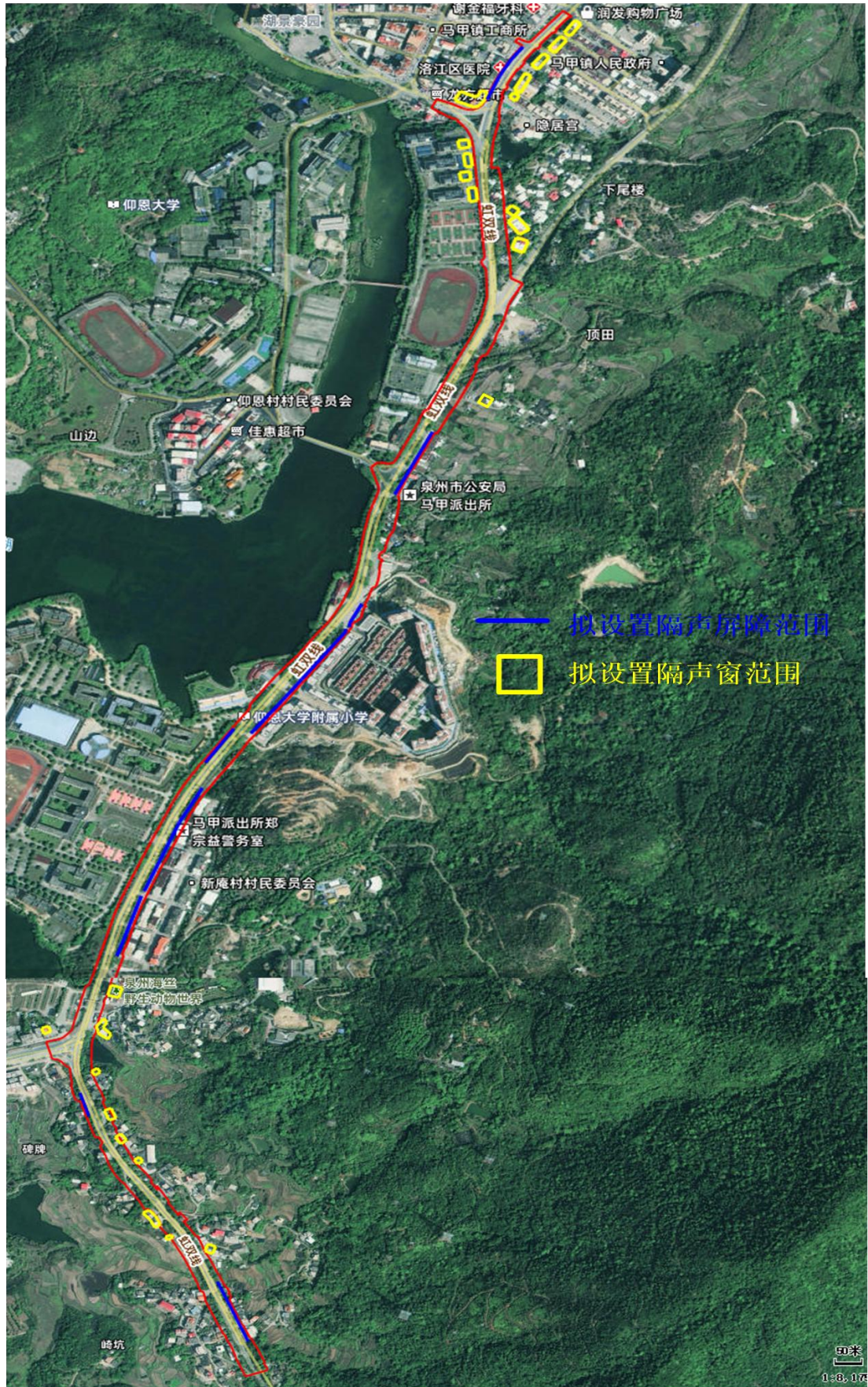
图 5.2-3 隔声窗、隔声屏障布设位置示意图
