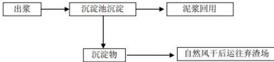
图3.7-5 钻孔时泥浆处理示意图
