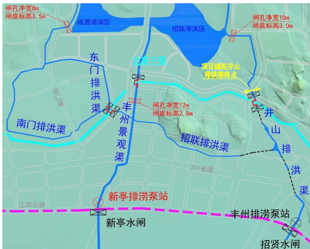
图5.1-1 井山排洪渠与北高干渠连通规划图
