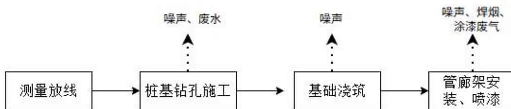
图 2-9 新建管廊段施工工艺流程图
