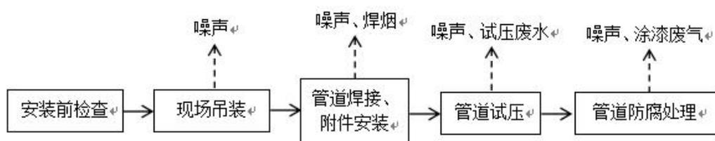
图 2-8 管廊段管道架空敷设施工工艺流程图
