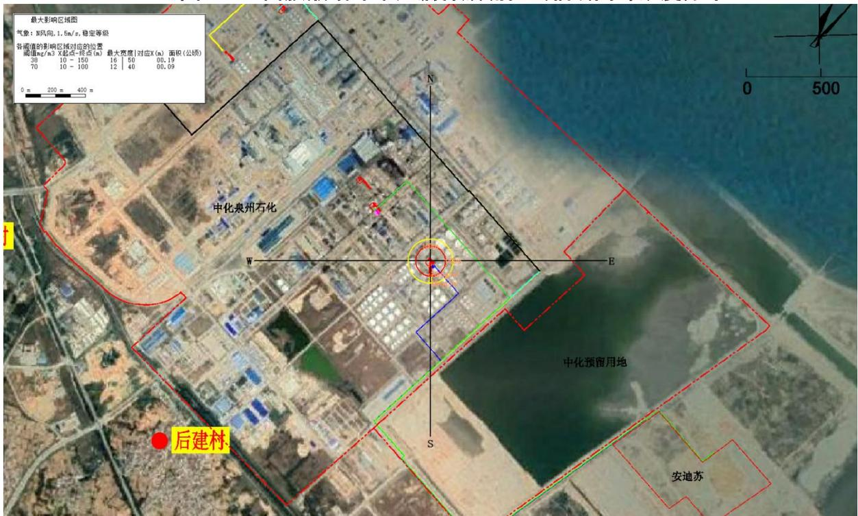
图 1.4-9 最不利气象条件下富胺液缓冲罐泄漏释放硫化氢毒性终点浓度影响范围
