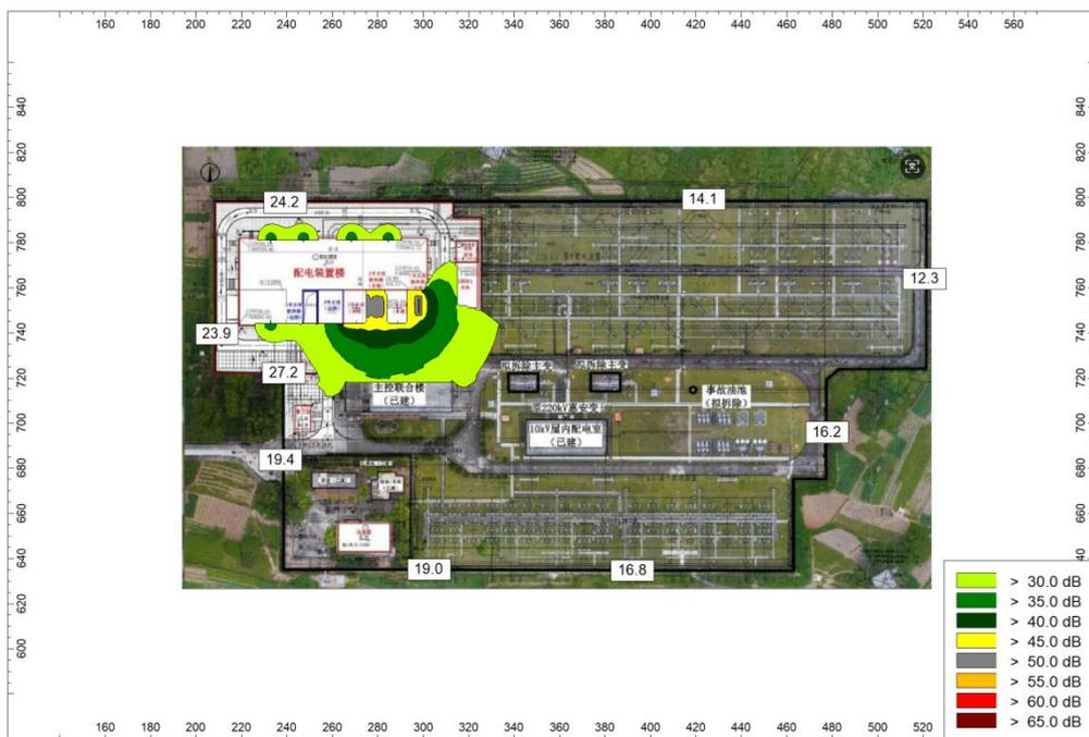
图 4-6 泉州惠安 220 千伏变电站改造工程噪声预测等值线图(本期,接收点为围墙上方 0.5m)
