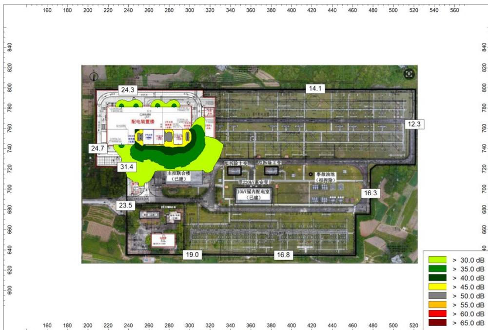
图 4-7 泉州惠安 220 千伏变电站改造工程噪声预测等值线图(终期,接收点为围墙上方 0.5m)
