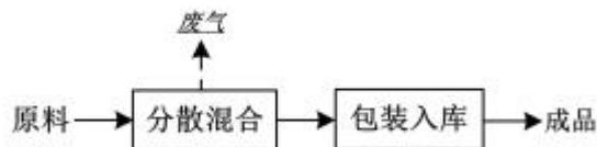
图2.10-4 水性聚氨酯涂料生产工艺流程及产污环节
