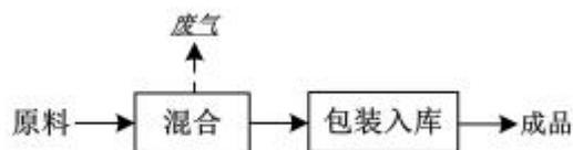
图2.10-5 聚合物水泥基防水涂料生产工艺流程及产污环节
