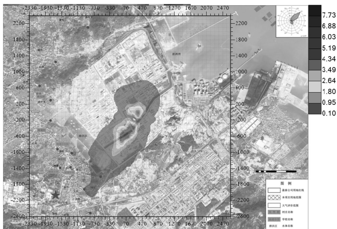
图 5.7-1 苯并[a]芘最大地面年平均沉积量等值线分布图 单位 \mu\text{g}/\text{m}^2
