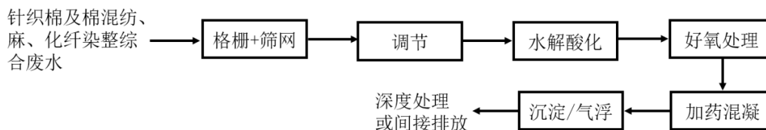
图 6.2-3 针织棉及棉混纺染整、麻染整以及化纤染整的综合废水常规处理工艺流程图
