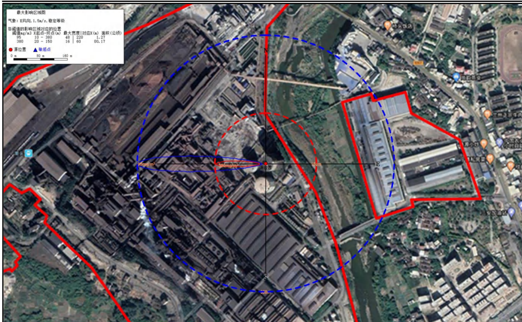
图 9.4-3 转炉煤气管道泄漏超过阈值最大轮廓线（最不利气象条件）
