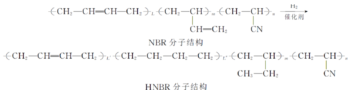
图 3.2-1 丁腈橡胶加氢法反应机理
