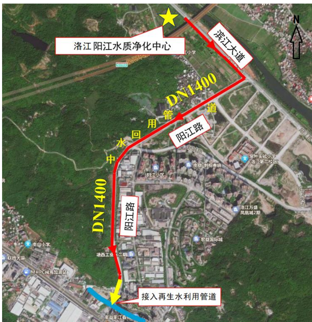
图 2.5-1 本项目中水回用管道走向示意图
