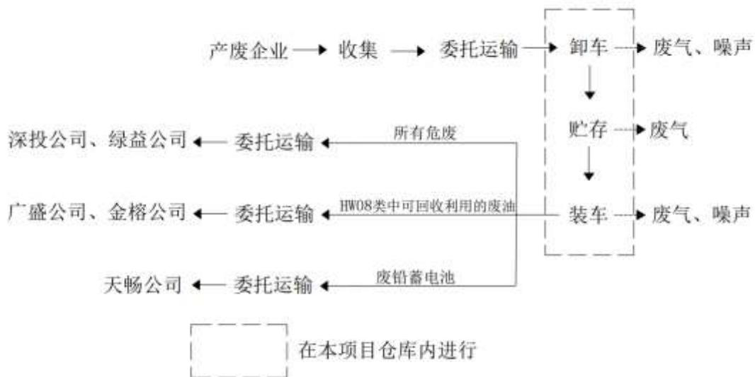
图 2-2 项目危废回收中转流程图
